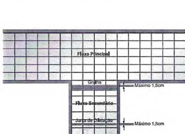
Figura 14 - Posicionamento de juntas e grelhas
