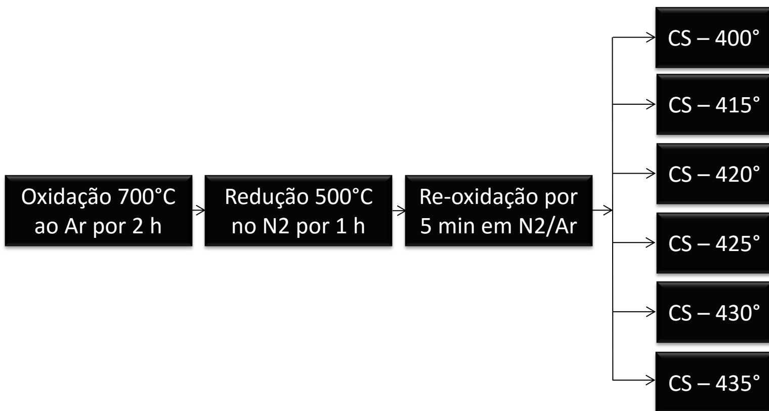
Figura 16: Esquema indicando as diferentes condições de síntese empregada e as diferentes amostras preparadas.
