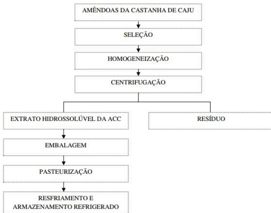
Figura 6 – Fluxograma do processo de obtenção do extrato hidrossolúvel da amêndoa de castanha de caju (ACC) antes da otimização.
