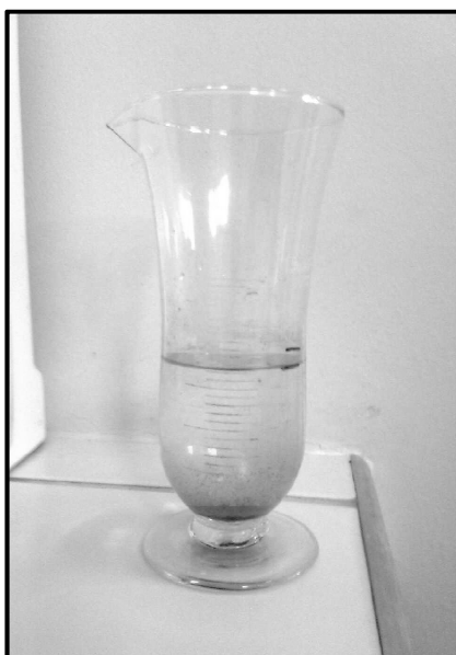
Figura 25. Sistema Zn-Ni: Formação de NiS após filtração de ZnS e ajuste de pH
