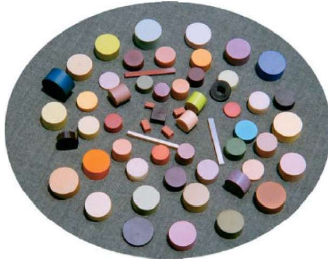
Figura 9 – Blocos de cerâmicas dielétricas desenvolvidas em laboratório.
