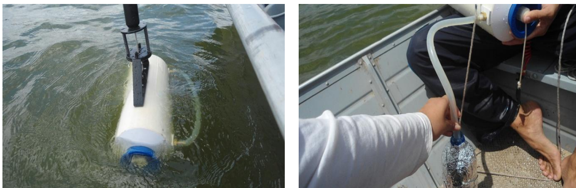
Figura 8 – Coleta de água no açude Marengo, na profundidade do disco de Secchi e utilizando garrafa de van Dorn
