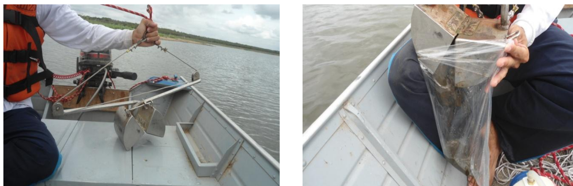
Figura 7 – Coleta de sedimento no açude Marengo, utilizando draga metálica
