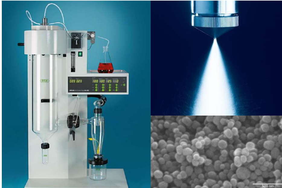
Figura 13: Ilustração de um (a) spray-dryer, (b) atomizador e (c) micrografia eletrônica de uma amostra de sílica secada via spray-drying.
