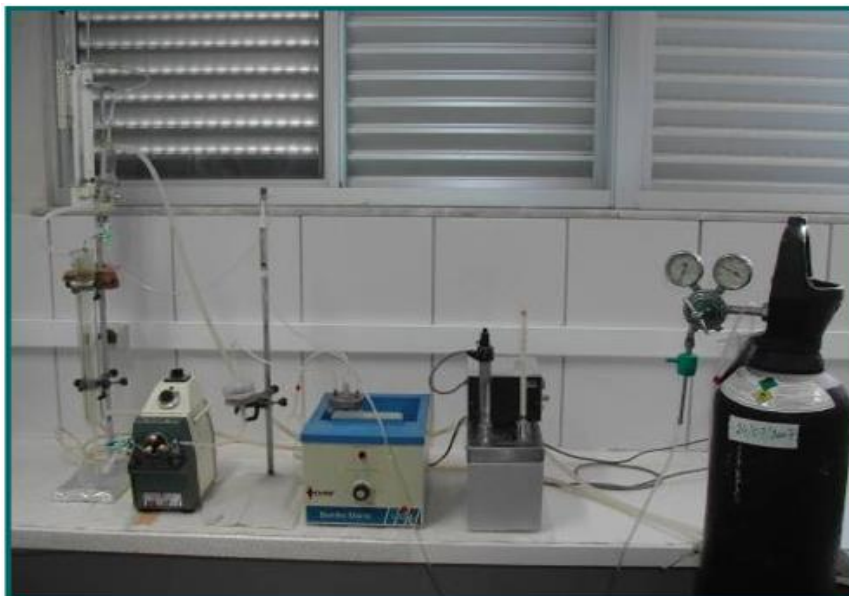
Figura 6. Sistema de perfusão de rim isolado.
