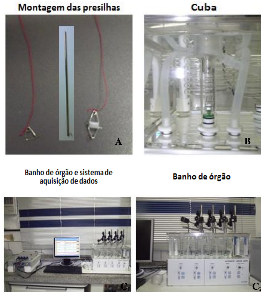
Figura 02 - Foto: Anéis armados no interior da cuba do banho de Órgãos (A); Foto: Armação dos anéis aórticos na haste suporte (B); Foto: Banho de órgãos (C 1 ); Foto: Sistema de aquisição de dados (C 2 ).
