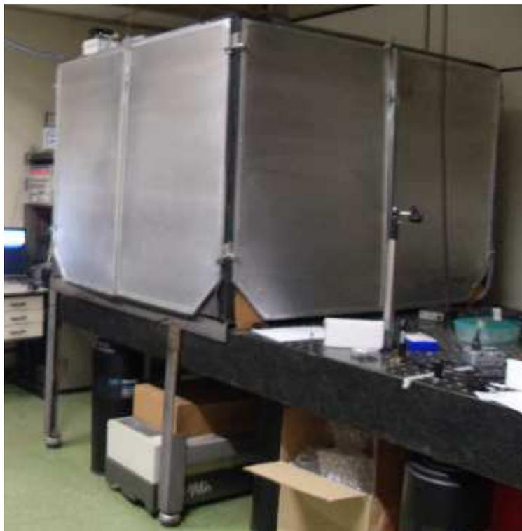
Figura 108: Ilustração do sistema de isolamento utilizado no LNS-UFMG.
