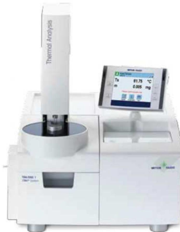
Figura 20: Ilustração do equipamento utilizado para a realização das medidas de TGA [45].
