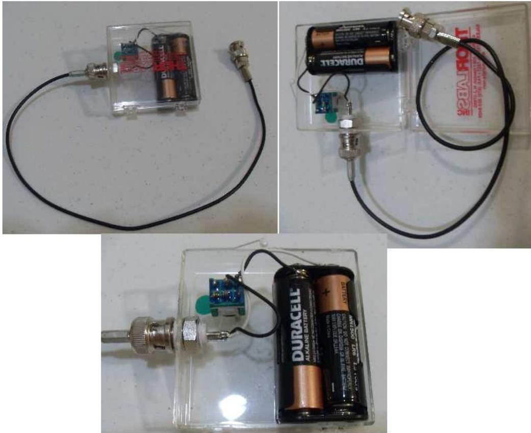
Figura 102: Bateria de  $\pm 3V$  utilizada na configuração deste trabalho.
