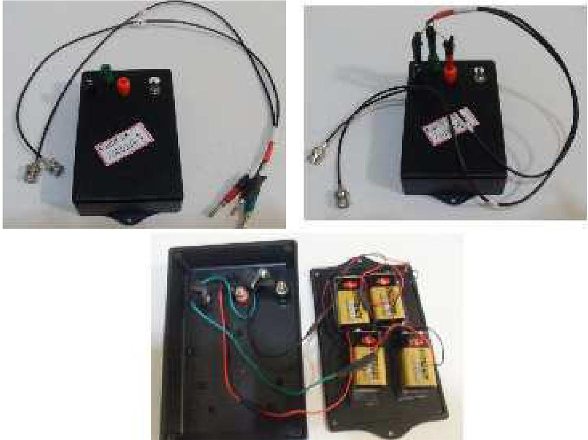
Figura 101: Bateria de  $\pm 36V$  utilizada na configuração descrita neste trabalho.
