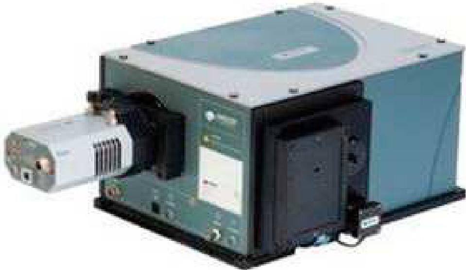
Figura 76: Espectrômetro e CCD que constituem o sistema.
