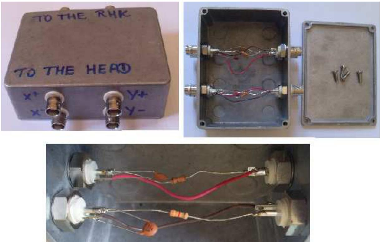
Figura 89: Ilustração mostrando como a caixa metálica I deve ser construída.
