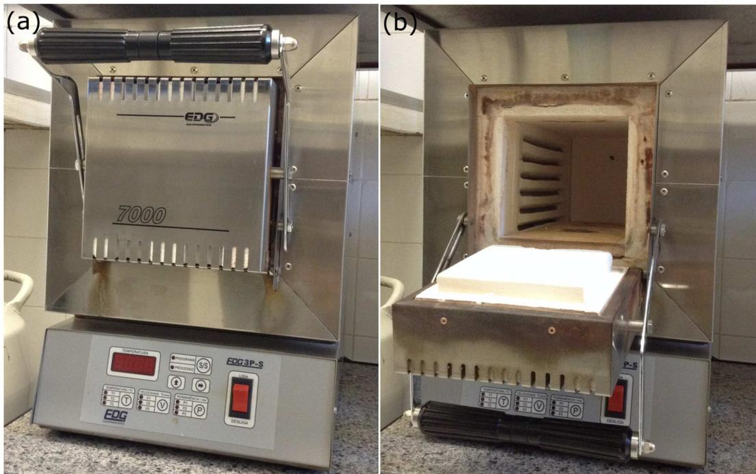
Figura 21: Forno Mufla utilizado nos experimentos mostrando a parte de fora (a) e de dentro (b) do forno.
