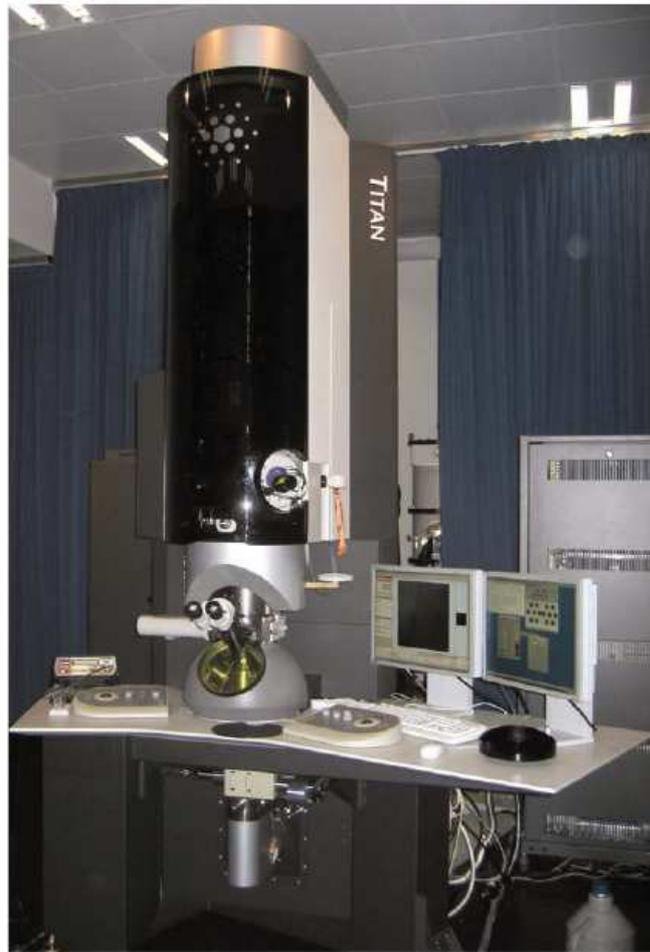
Figura 24: Ilustração de um dos mais modernos equipamentos TEM que utilizamos para a obtenção das imagens de transmissão descritas nesta tese [59].
