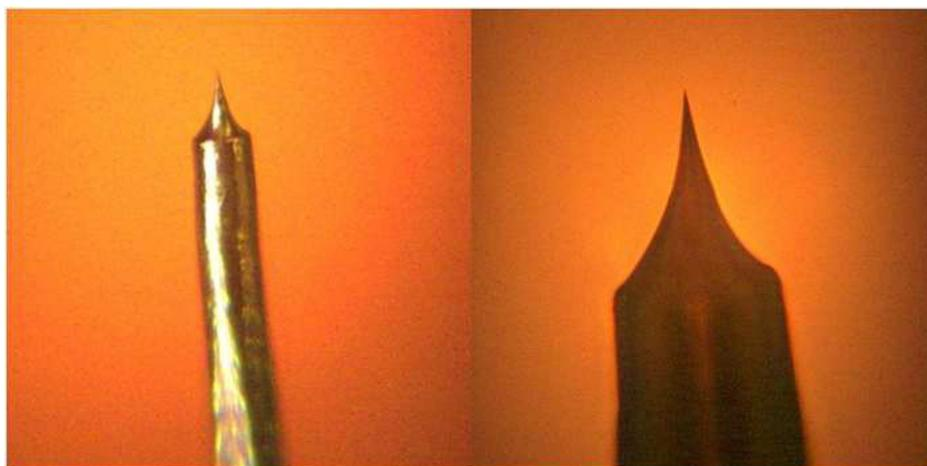
Figura 104: Imagem obtida por um microscópio óptico convencional da ponta de ouro.
