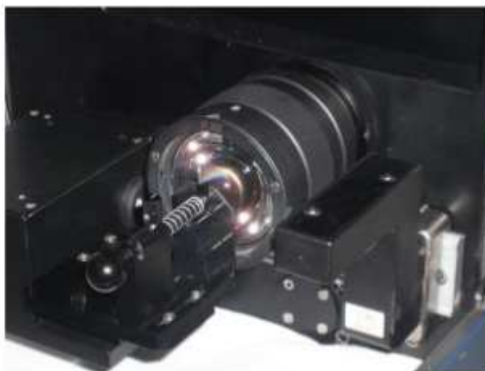
Figura 3.5: Compartimento onde a amostra é colocada para medidas FT-Raman
