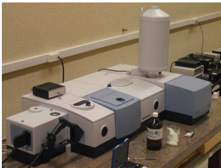
Figura 3.4: Espectrômetro Raman por transformada de Fourier utilizado nos experimentos dessa dissertação.
