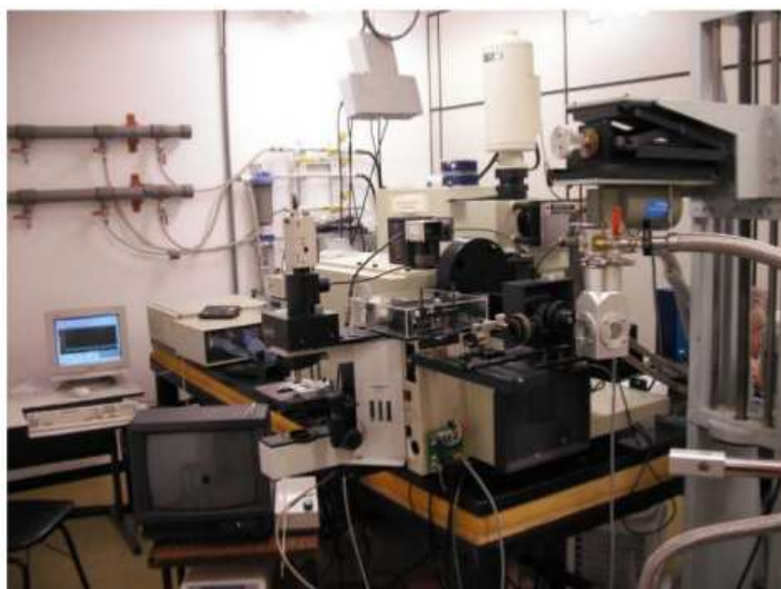
Figura 3.6: Espectrômetro Raman T64000 (fabricante Horiba Jobin Yvon).
