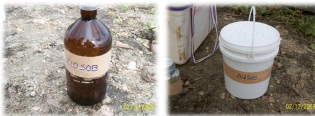
Figura F - Detalhe do frasco de 1L escuro, para análise da DBO; e frasco de cinco litros, para análise dos nutrientes.
