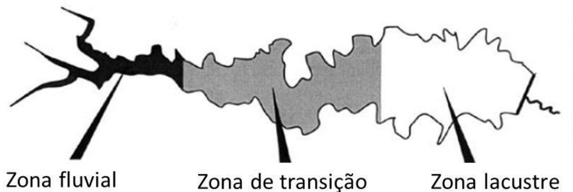
Figura 6 – Zonação longitudinal das condições hidrodinâmicas em reservatórios formados pelo barramento de rios.
