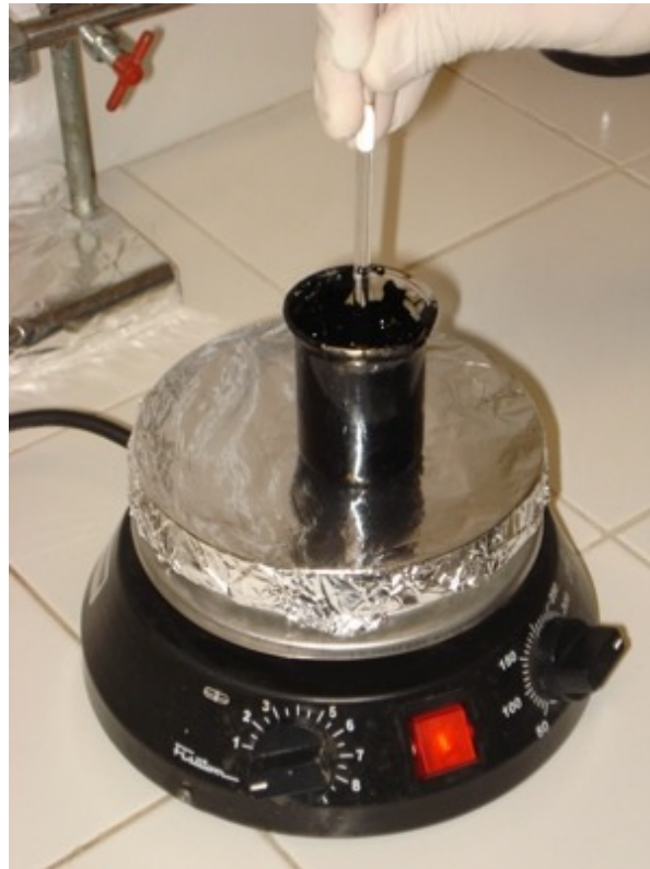
Figura 40: Homogeneização da amostra para evitar exame de fases separadas devido à não estabilidade total à estocagem do CAP.
