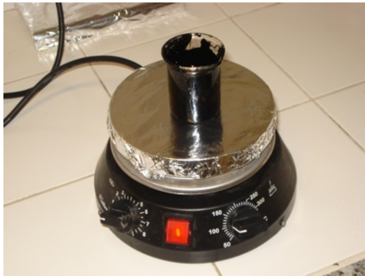
Figura 39: Aquecimento do CAP até 100 °C para remoção de amostra e posterior confecção da lamínula para análise mecânica.
