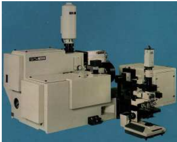
Figura 6. Espectrômetro Raman do Departamento de Física da UFC [10]
