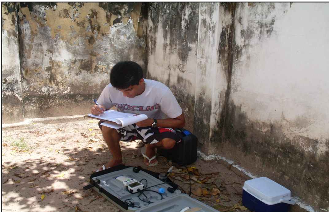
Foto 12 – Medição dos parâmetros (pH,STD, condutividade elétrica, resistividade e salinidade) no período de monitoramento no chafariz do Pau-Pombo (jan/2012 ). Coord.:9561997/573021
