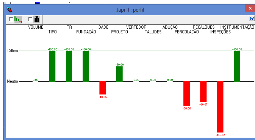
FIGURA 81 - Perfil multicritério da barragem Japi II.
