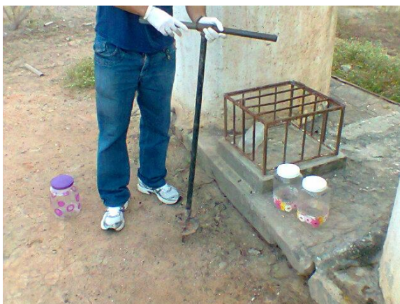
Figura 17 - Trado utilizado para a coleta da massa de resíduo através do topo dos lisímetros.
