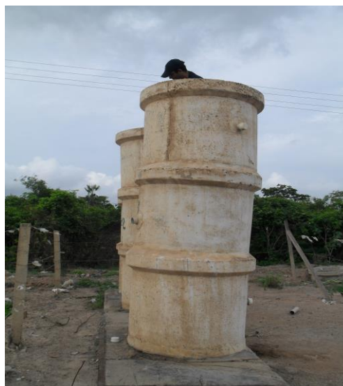
Figura 25 - Medição dos gases no bocal de saída acima da camada de cobertura nos lisímetros.
