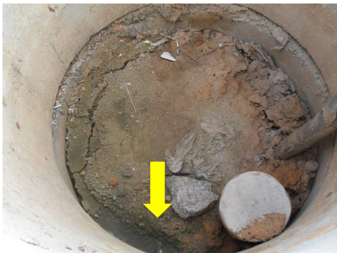
Figura 52 - Indicação de um local de maior rebaixamento da massa de resíduos.
