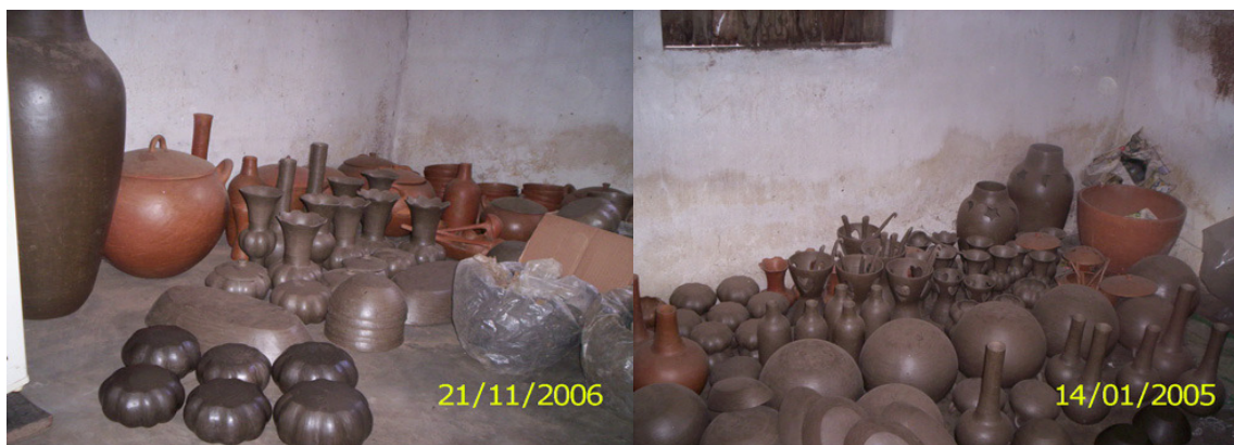
Figura 08 – As peças avermelhadas já estão queimadas, mas as de tom cinza escuro estão em processo de secagem. É possível ver ainda, na foto da esquerda, montes de barro cobertos com sacos plásticos para impedir o ressecamento. Fonte: Francisca Mendes. Acervo pessoal. 2006.
