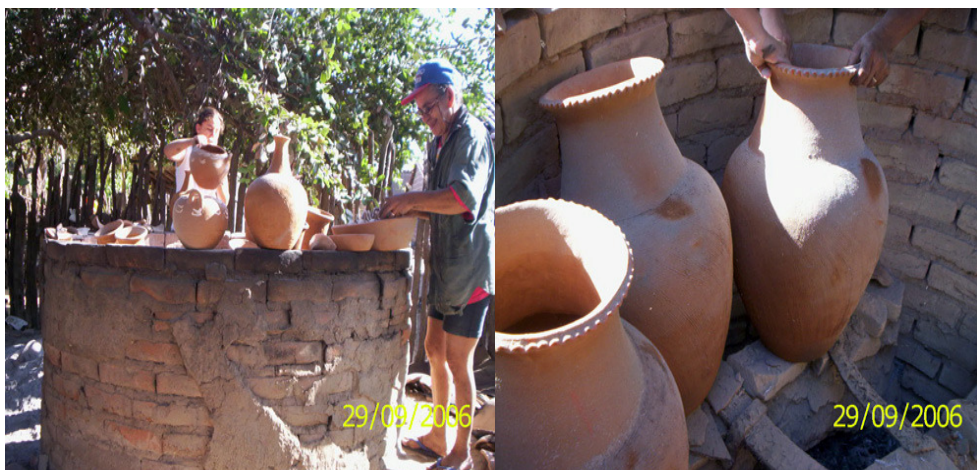
Figura 25 – A louça sendo retirada do forno. À esquerda, algumas “peças miúdas” como quartinhas. À direita, potes sendo puxados para fora. Fonte: Francisca Mendes. Acervo pessoal. 2006.
