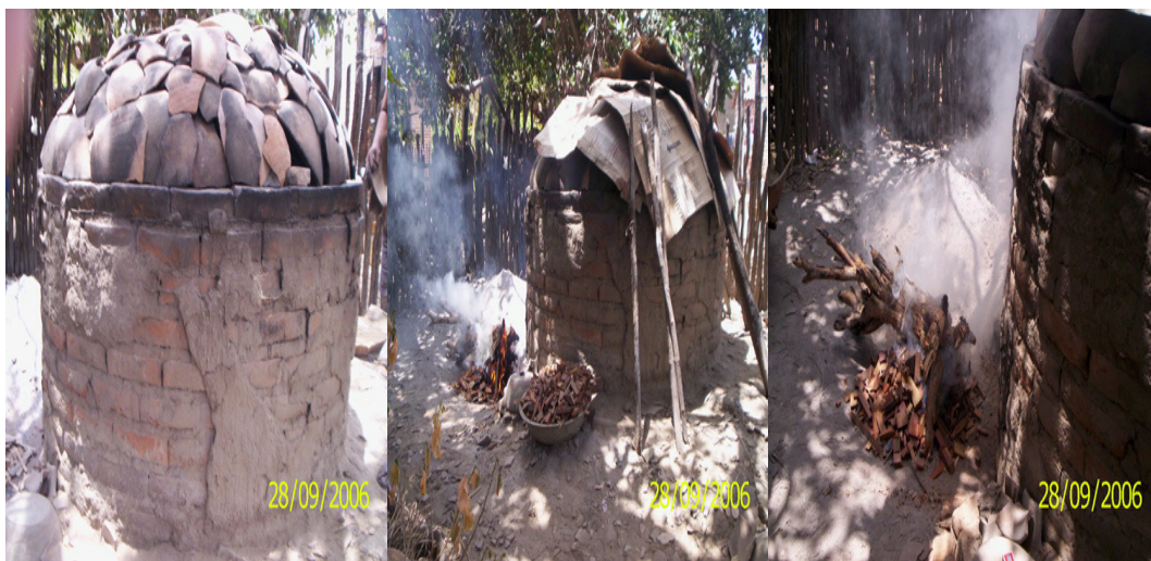
Figura 23 – À esquerda, o forno coberto com os cacos , pronto para começar a queima. No centro e à direita, o início do processo, quando o fogo não foi ateado dentro dele. Fonte: Francisca Mendes. Acervo pessoal. 2006.
