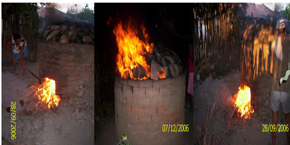
Figura 24 – Parte final da queima. O forno já está com uma grande quantidade de brasas em seu interior (à esquerda) e é dada a calda ; são produzidas labaredas que ultrapassam a altura do forno (centro) e o cobrem (à direita). Fonte: Francisca Mendes. Acervo pessoal. 2006.
