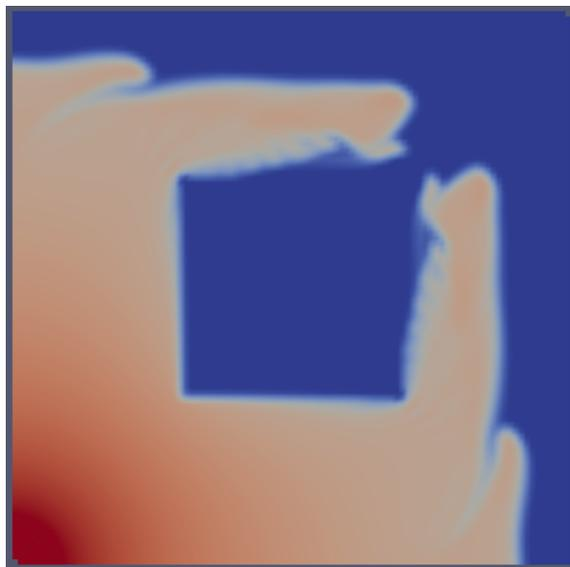
Figura 39: Simulação do escoamento bifásico em uma configuração do tipo 1/4 de five spot, após 1500s, contendo um injetor no canto inferior esquerdo e um produtor no canto superior direito, com uma região central de baixa permeabilidade. Dados do problema:  $dt = 0.1$ ,  $pw_{inj} = 3e6Pa$ ,  $pw_{prod} = 1e6Pa$ ,  $k = 1e - 8m^2$ ,  $k_{low} = 1e - 11m^2$ ,  $\rho_w = 1000kg \cdot m^{-3}$ ,  $\mu_w = 1e - 3Pa \cdot s$ ,  $\mu_n = 1e - 2Pa \cdot s$ ,  $\theta = 2$ ,  $\phi = 0.2$ .
