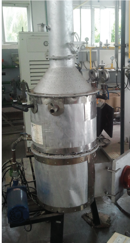
Figura 31: caldeira geradora de vapor modelada.
