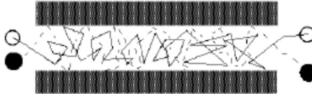
**Figura 4.2** – Representação esquemática da difusão molecular
