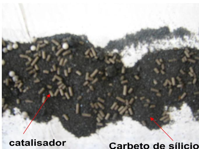
**Figura 9.4** – Catalisador após o descarregamento do reator ao término da Corrida 3.
