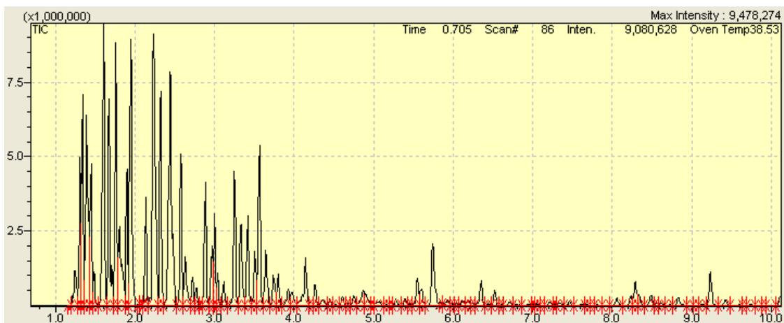
**Figura A.2.10** – Composição da gasolina após 24 horas de ensaio de imersão em contato com o carbono ativado GF45/PdCl<sub>2</sub>, numa temperatura de 30°C.
