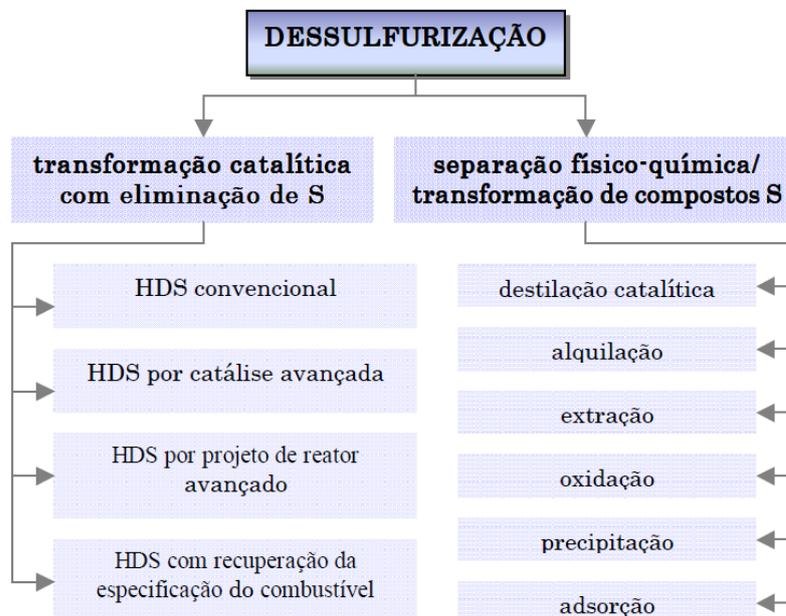
**Figura 2.2:** Tecnologias de dessulfurização classificadas pela natureza do processo chave para remover enxofre. Babich e Moulijn (2003).
