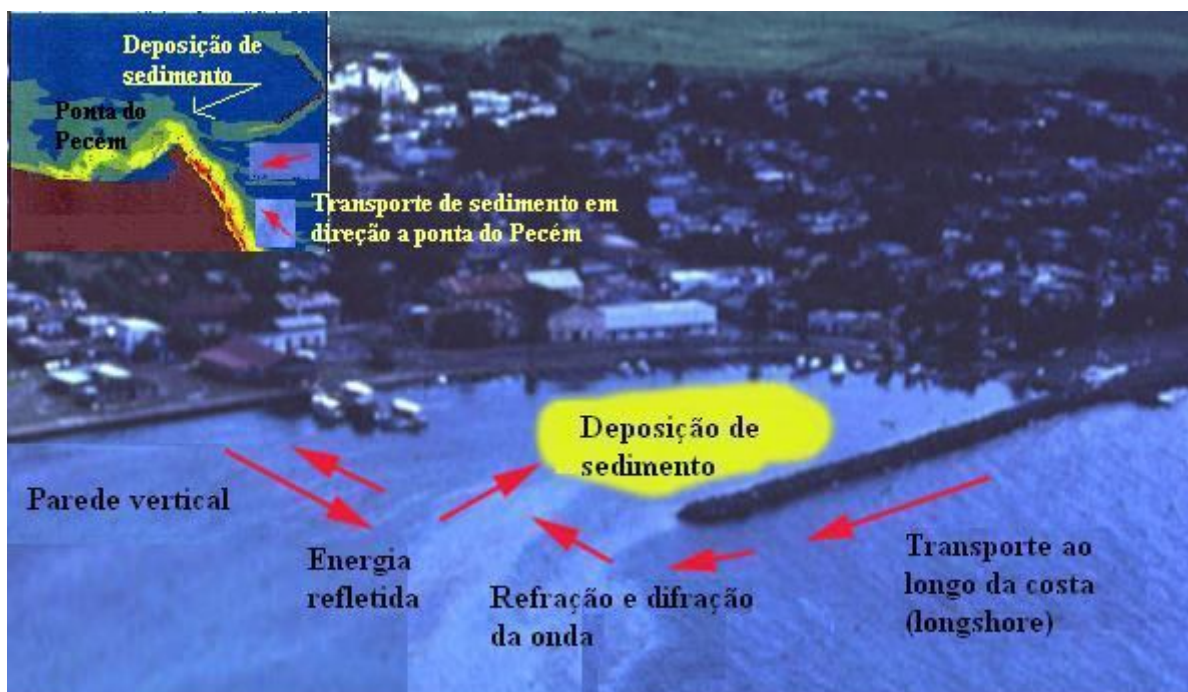
Figura 4 – Transporte de sedimento decorrente da interação refração/difração na costa de Porto Rico e a ocorrência no litoral do Porto do Pecém com o transporte dirigindo-se à ponta do Pecém.
