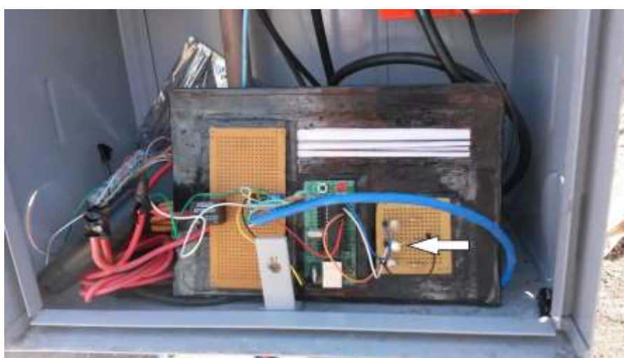
Figura 29: Led B5 (cor branca) aceso, indicando motobomba ligada
