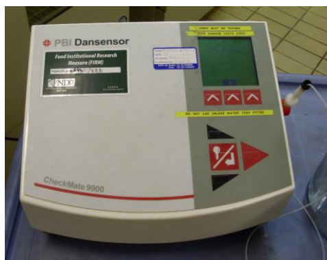
Figura 7 – Equipamento usado para medir a composição dos gases O 2 e CO 2 , analisador de gases (Checkmate, 9900, PBI Dansensor)
