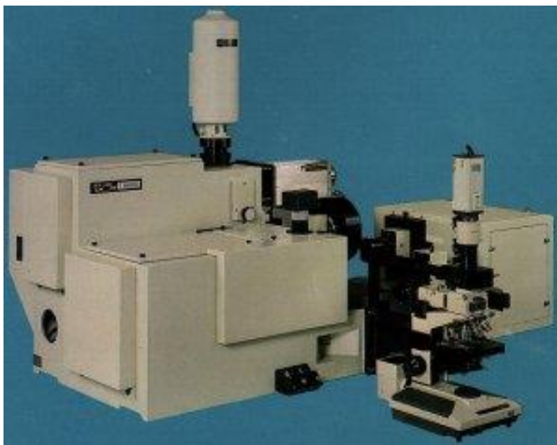
Figura 9 Espectrômetro Jobin-Yvon T64000 usado nas medidas de espalhamento Raman.
