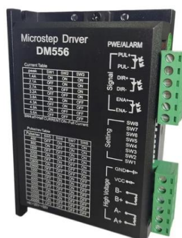
Figura 6 – Driver utilizado no controle do motor
