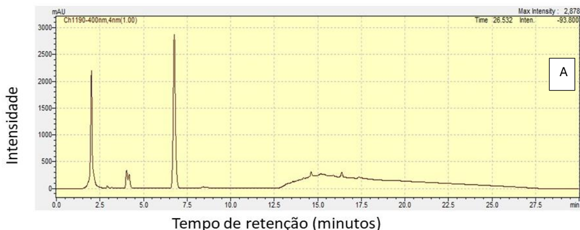
Figura 4 – Cromatograma obtido do extrato de alho (A) e utilizando acetonitrila (B)
