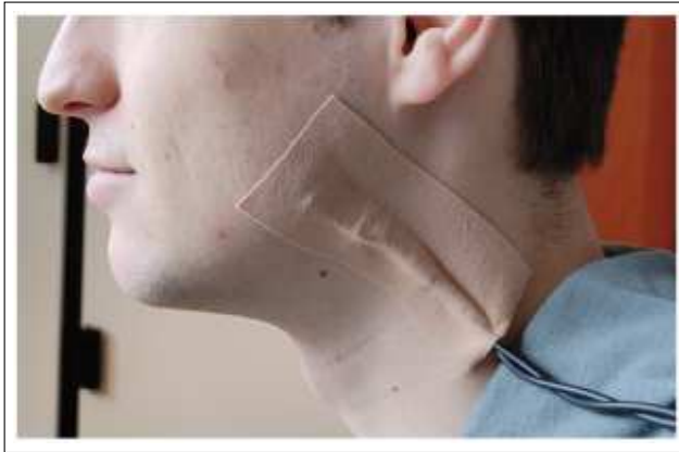
Figura 15 – Sensor Piezoelétrico Posicionado na Mandíbula do Paciente
