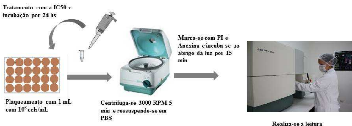
Figura 10- Desenho esquemático da determinação da integridade da membrana.
