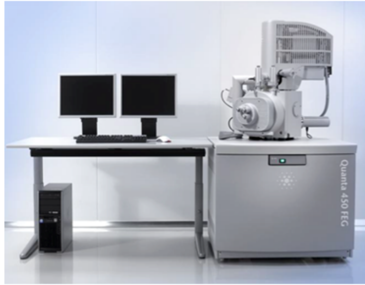
Figura 9: Microscópio Eletrônico de Varredura Quanta 450 FEG-FEI.
