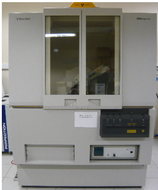
Figura 8: Difratorômetro para amostras policristalinas modelo XPert Pro MPD – Panalytical.
