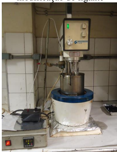
Figura 3.5 - Visualização do equipamento Silverson®, no momento da mistura para modificação do ligante
