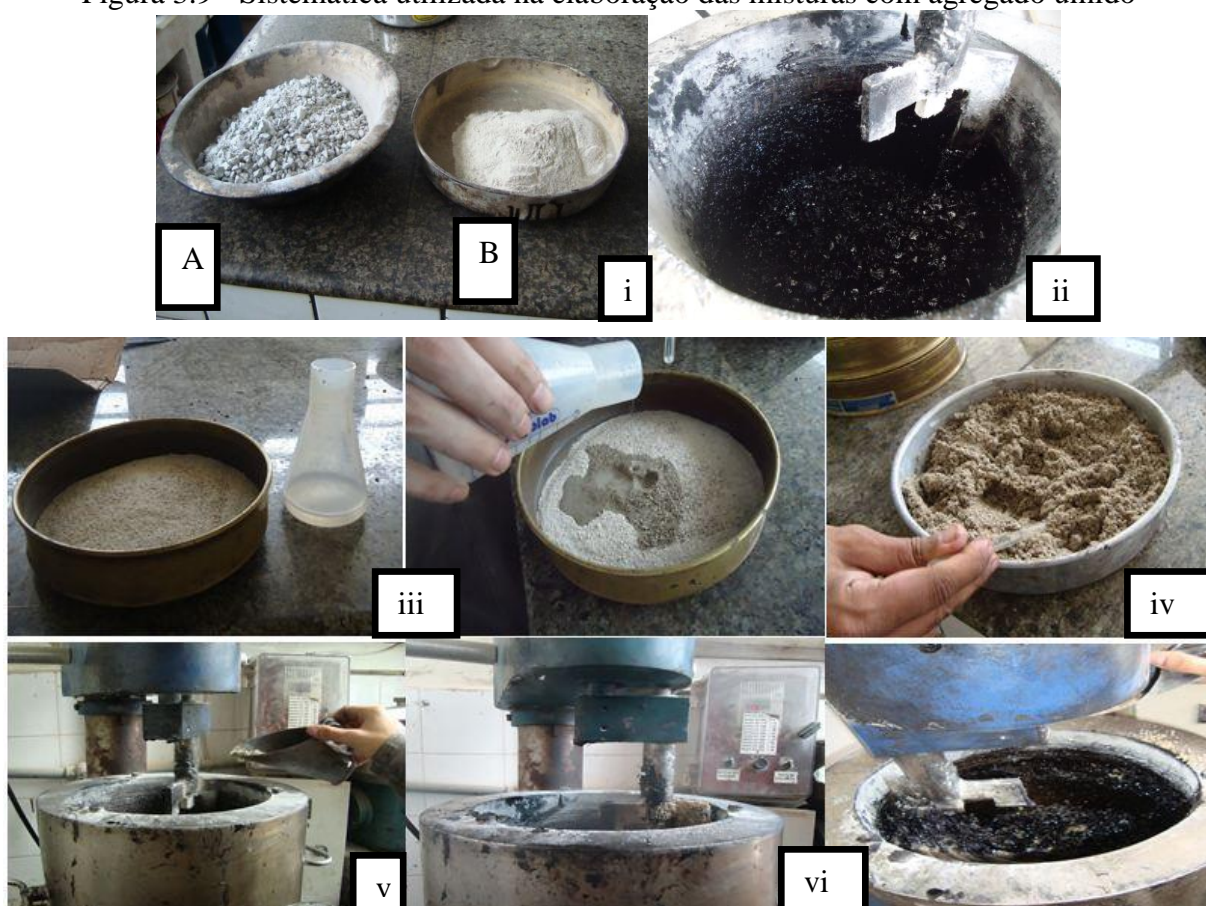
Figura 3.9 - Sistemática utilizada na elaboração das misturas com agregado úmido
