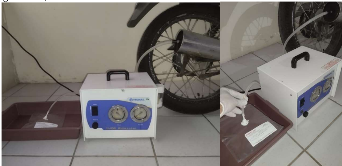
Figura 7 – Imagens da amostragem dos gases de exaustão na saída do escape veicular utilizando a bag Tedlar 1,0 L
