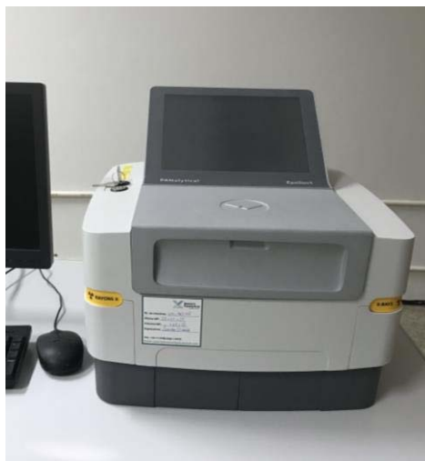
Figura 9 - Equipamento utilizado no ensaio FRX.
