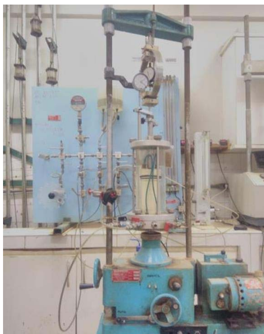
Figura 11 - Equipamento utilizado nos ensaios triaxiais
