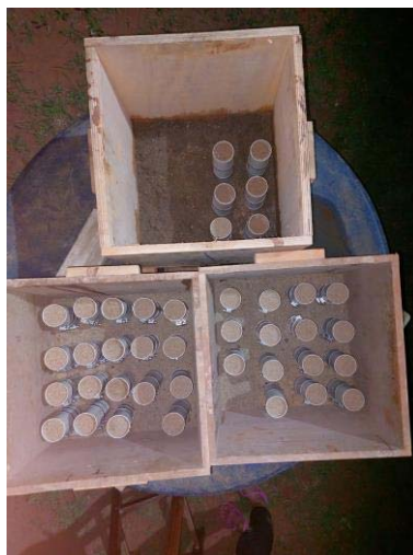
Figura 24 - Corpos de prova expostos aos agentes climáticos
