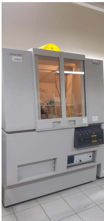
Figura 14 - Equipamento utilizado no ensaio de DRX
