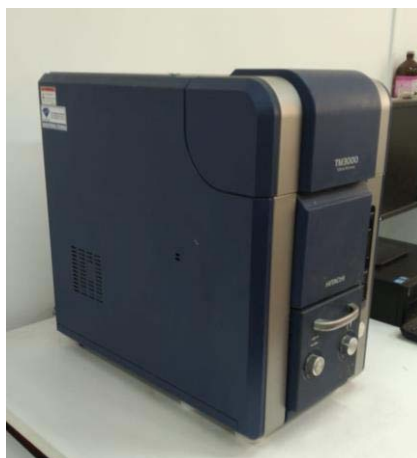
Figura 17 - Equipamento utilizado no ensaio MEV
