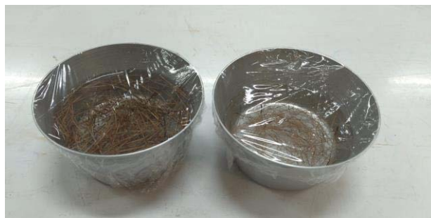
Figura 16 - Preparo de amostras para o ensaio MEV – fibras imersas
