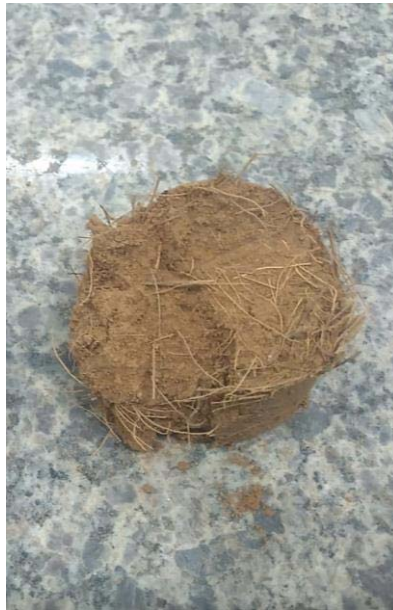
Figura 15 - Corpo de prova do compósito da amostra de fibra completa (SAFC) do tempo t_4 antes de ser lavado na peneira
