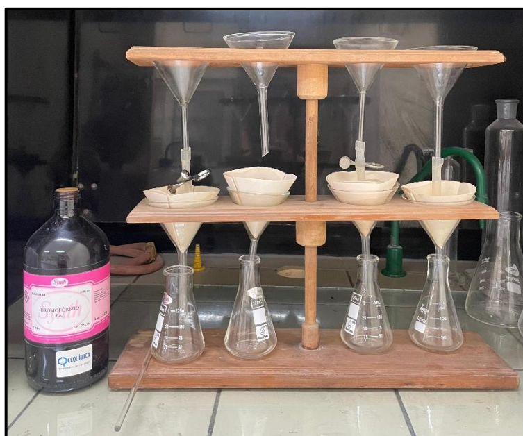
Figura 19 - Separação dos minerais pesados em funis com válvulas e filtros, e uso de bromofórmio.
