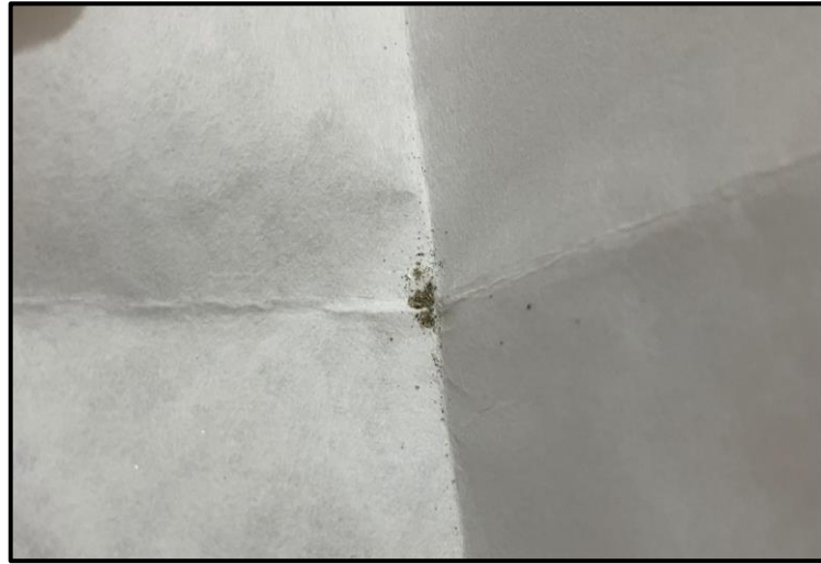
Figura 20 - Exemplo da quantidade de minerais pesados retidos pós separação densimétrica e magnética.
