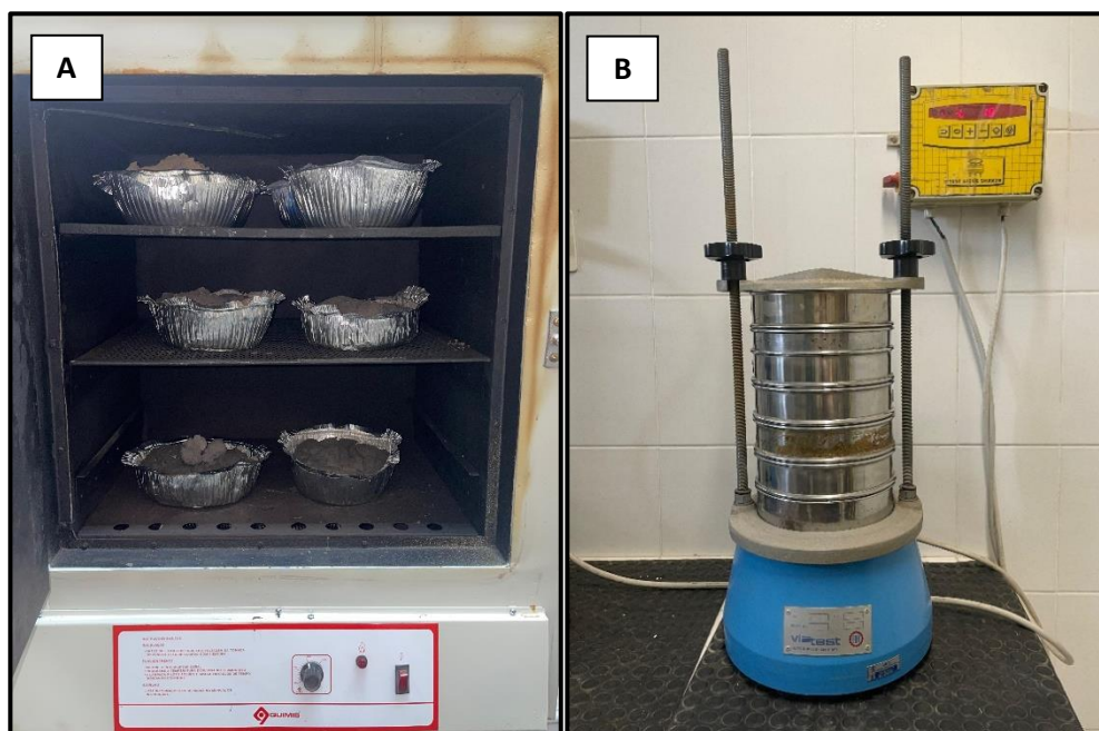
Figura 23 - Amostras postas para secagem na estufa em A e durante o peneiramento no agitador mecânico, em B.
