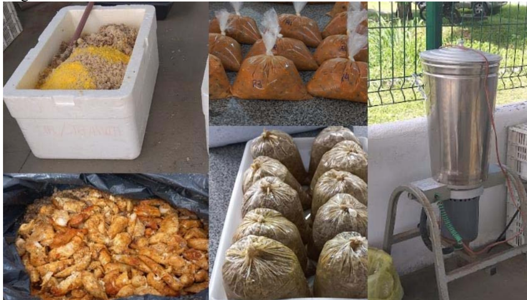
Figura 9 - Substrato utilizado e liquidificador industrial na área de produção de biogás - LARSE/NUTEC/UFC
