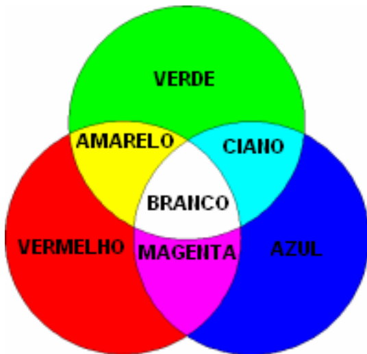
FIGURA 13 – Mistura das cores primárias (vermelho, verde e azul) produzindo as cores secundárias (magenta, ciano e amarelo) e a luz branca.
