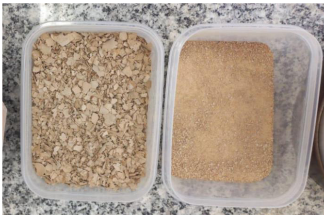
Figura 7 – Solo ao ser retirado da estufa e após o peneiramento.
