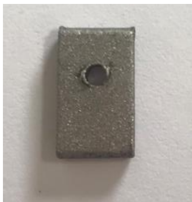
Figura 7 - Corpo de prova usinado em de aço carbono 1020 seguido de jateamento abrasivo.
