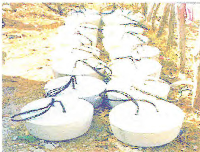
FIGURA 4- Estruturas de fundeamento feitas em concreto armado ( \cong 60 kg) com dois orifícios centrais, por onde eram colocados os cabos de polietileno ( \phi 6 mm).
