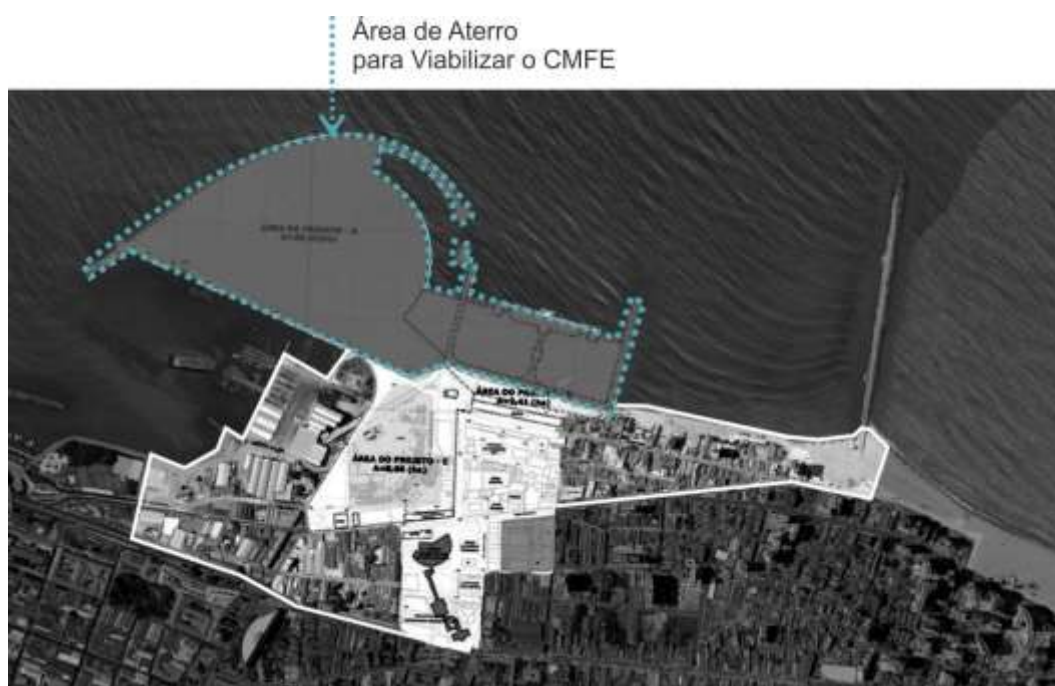
Figura 13 – Área do aterro para a viabilização do CMFEC
