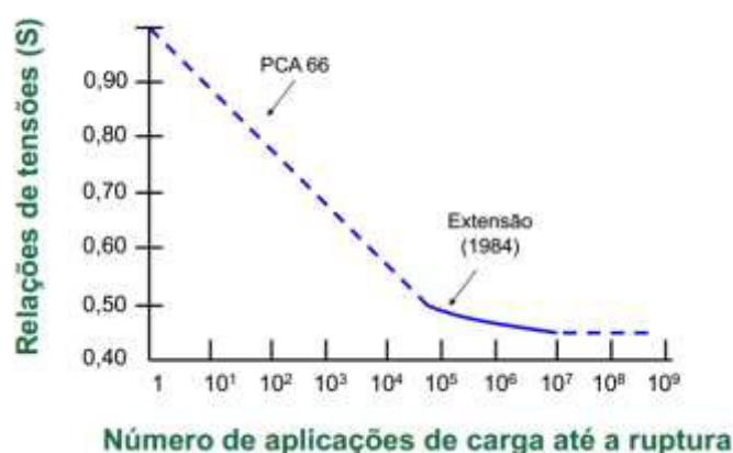
Figura 23 - Relação entre tensões e o número de aplicações pelo método PCA
