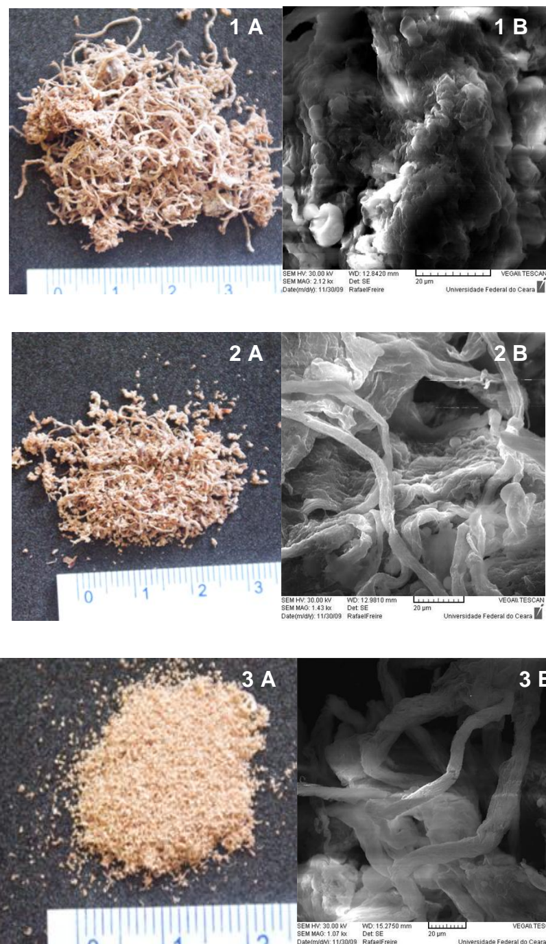
Figura 22 – Diferentes granulometrias dos bagaços tratados com e sem enzimas. 1 A e 1B- O bagaço retido nas peneiras de abertura entre 2 e 16 mm; 2 A e 2 B- O bagaço retido nas peneiras de abertura entre 0,25 e 2 mm; 3 A e 3 B-O bagaço retido nas aberturas igual ou menor que 0,25 mm.
