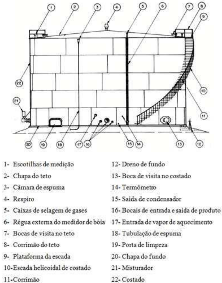
Figura 4 – Elementos de um tanque de armazenamento
