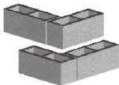
Figura 18 - amarração c/ modulação e larguras diferentes, sem uso de bloco especial.
