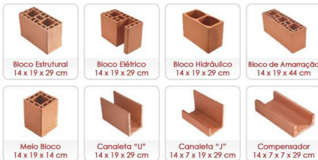
Figura 4 - Blocos estruturais cerâmicos da família 29
