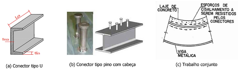
Figura 5 – Conectores de cisalhamento soldados a viga metálica.
