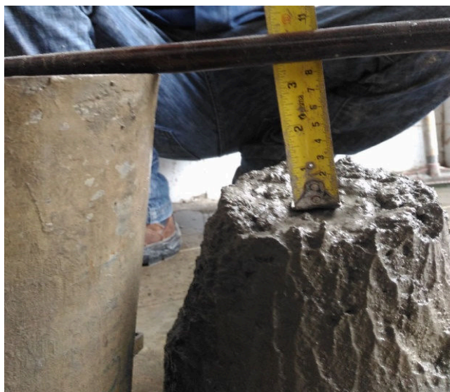
Figura 6 - Teste de abatimento do tronco de cone.
