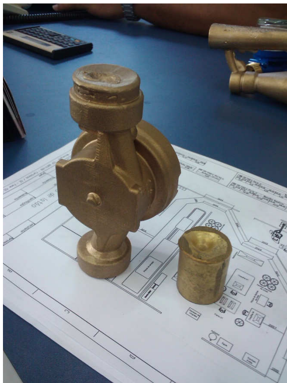
FIGURA 11 – Eliminação de apara de fundição pela melhoria na tecnologia de processo Fonte: o Autor.
