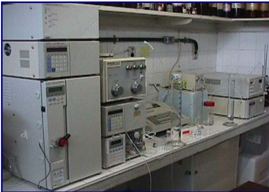
Figura 3 - Aparelho de HPLC com detecção de fluorescência e eletroquímica. Laboratório de neurofarmacologia do Departamento de Fisiologia e Farmacologia-UFC.
