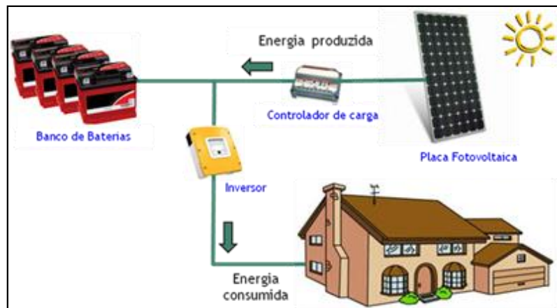
Figura 9. Sistema fotovoltaico doméstico isolado
